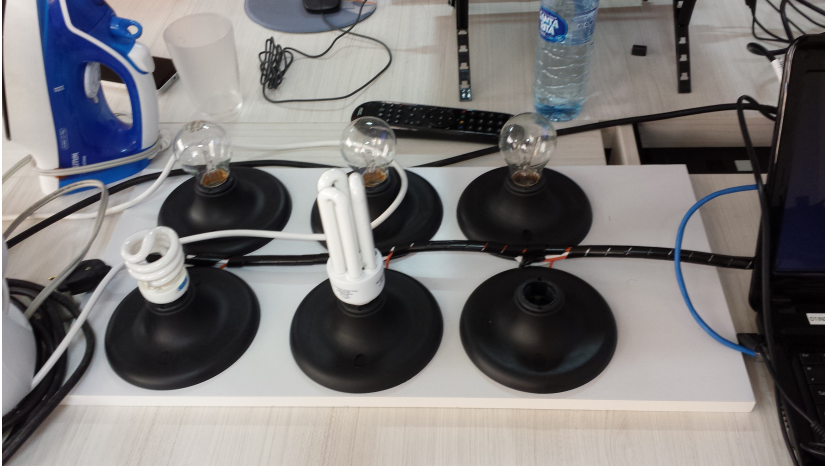
Figura 5.1.2 – Conjunto de cargas físicas.
