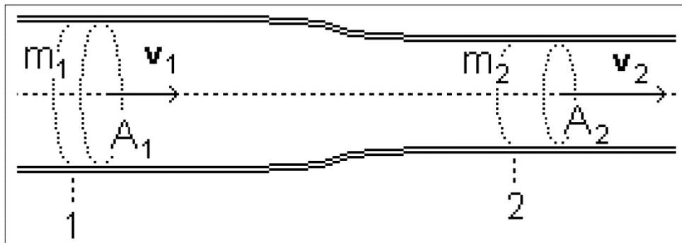
*Figura 30 – Ilustração da Equação da Continuidade. [31]*
