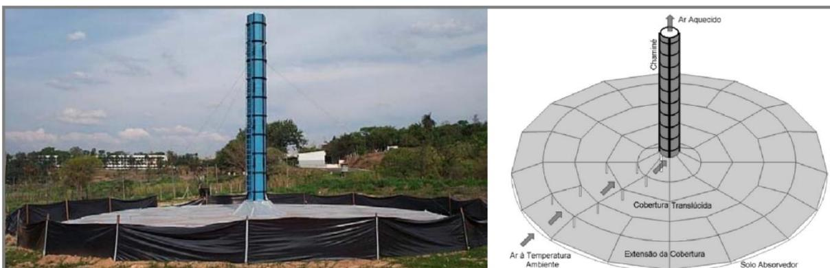
*Figura 9 - Protótipo de uma chaminé solar desenvolvida na UFMG [17].*
