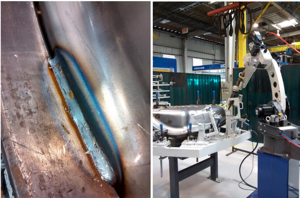
Figura 6.2: Junta soldada com robô (esquerda) e robô utilizado para teste (direita).
