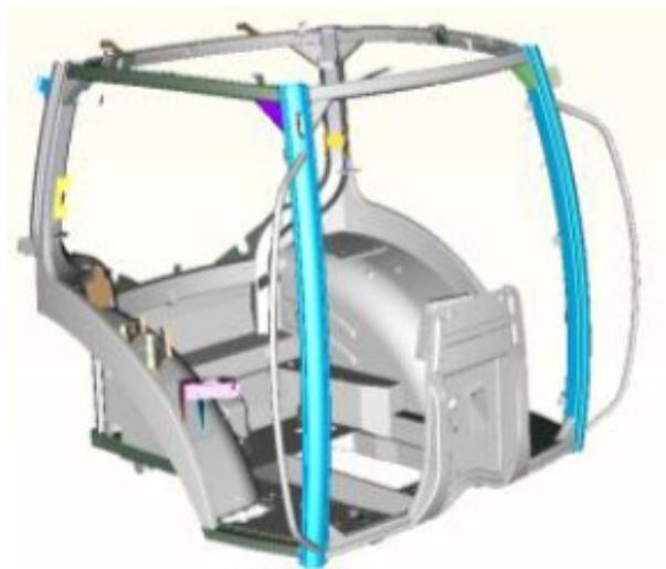
Figura 1.4: Cabine soldada na terceira célula a ser robotizada
