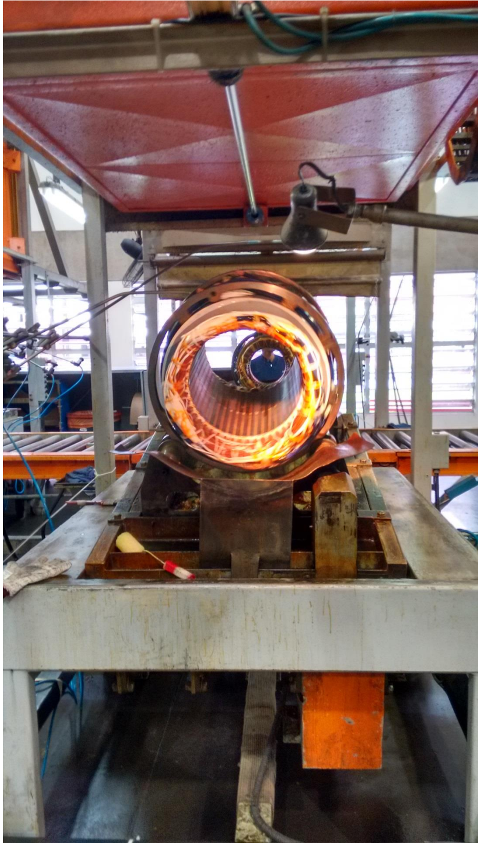
Figura 2 Processo de impregnação, etapa de gotejamento
