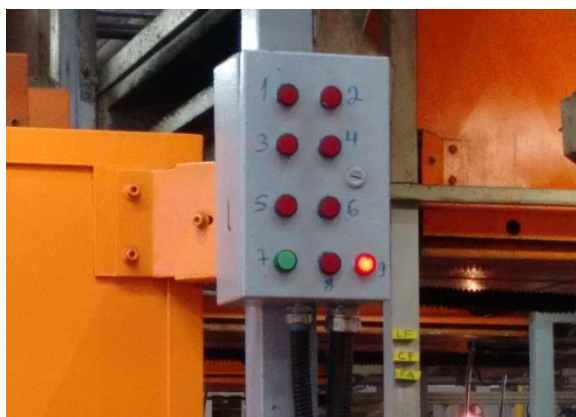
Figura 4 Painel com o indicador de que o término da cura está próximo
