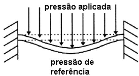
Figura 2.14: Diagrama típico do diafragma de um transdutor de pressão (EATON, W. P.; SMITH, J. H., 1997)
