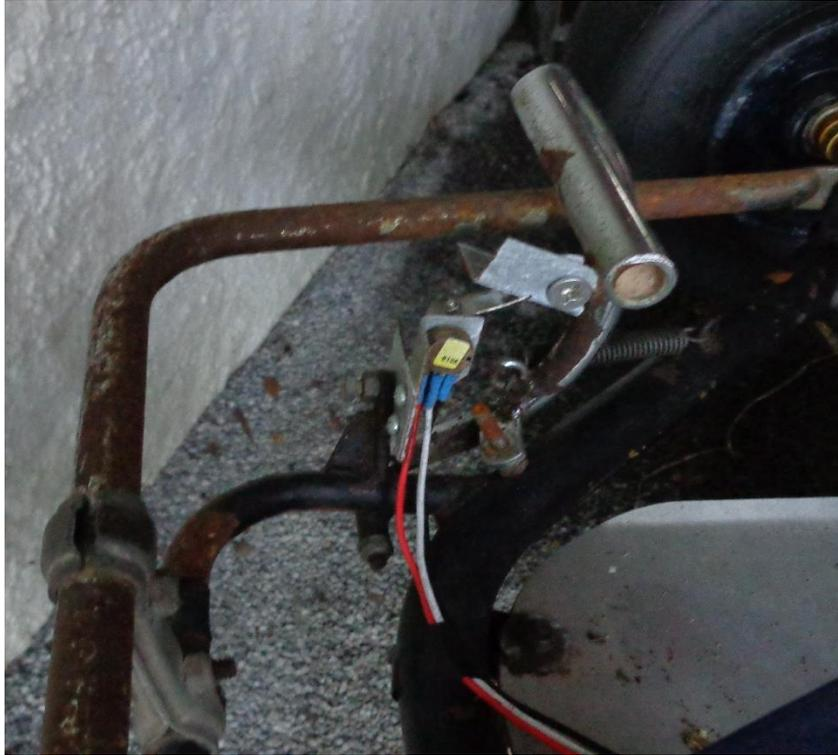
*Figura 19 - Potenciômetro no pedal*
