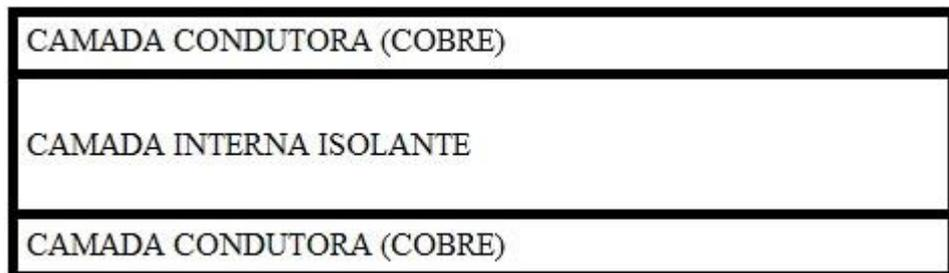
Os “fios” que conduzirão o sinal elétrico entre os componentes da PCI são denominados “trilhas”. Sendo necessário conectar uma trilha da camada condutora superior a uma outra trilha da camada condutora inferior, essa conexão será feita por meio de um furo na PCI. Esse furo é denominado “via” e possui paredes metalizadas para permitir a condução de corrente elétrica.
