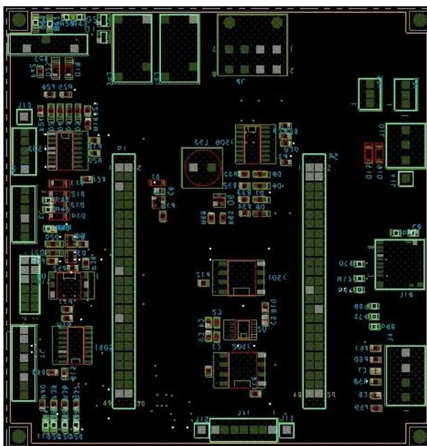
Figura 23 – Malha de GND superior.
