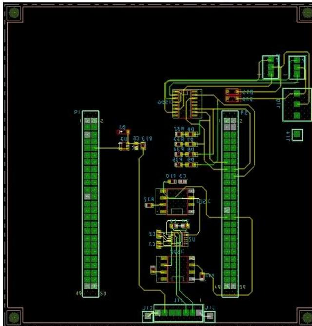
Figura 19 – Posicionamento e roteamento do terceiro e quarto conjuntos de componentes.
