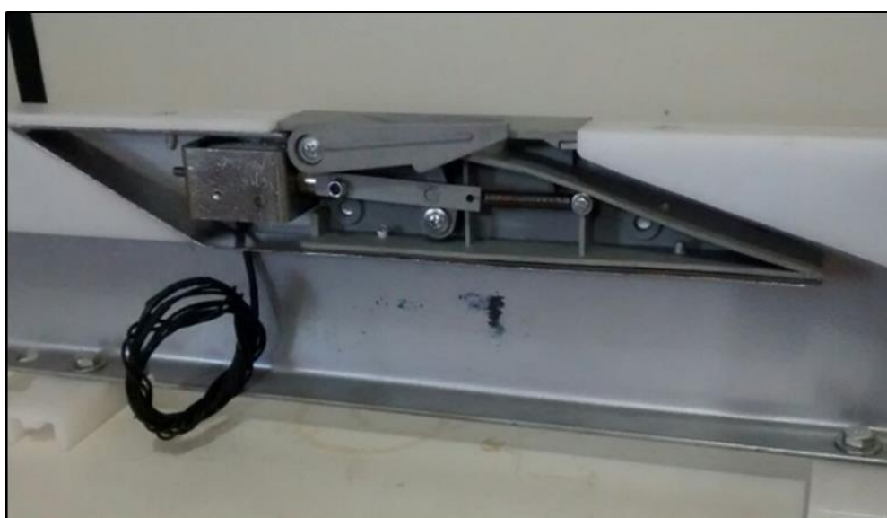
Figura 7 – Solenoide fixada no guia
