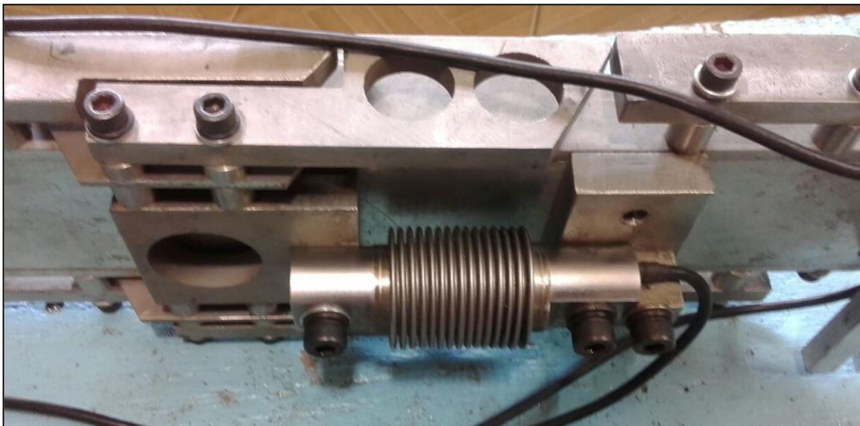
Figura 4 – Base de célula de carga com célula de carga z6c3/10 kg
