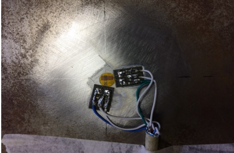
Figura 20 – Configuração de um dos extensômetros colados nos corpos de prova
