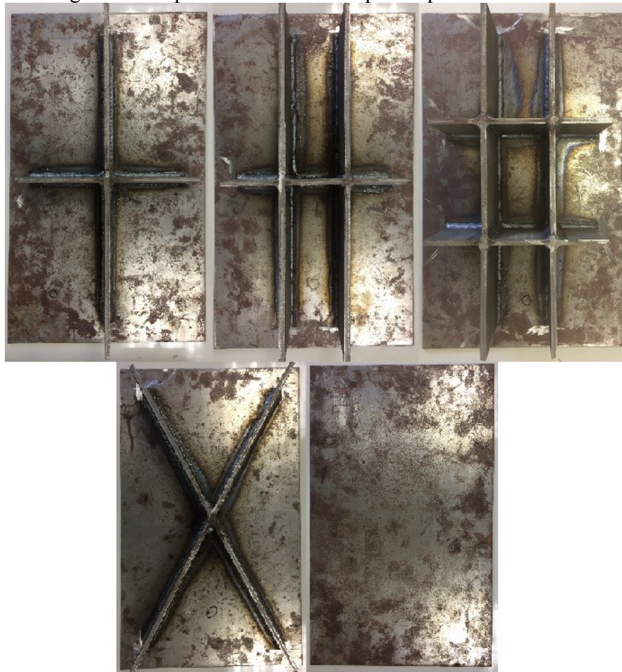
Figura 16 – Aparência final dos corpos de prova construídos
