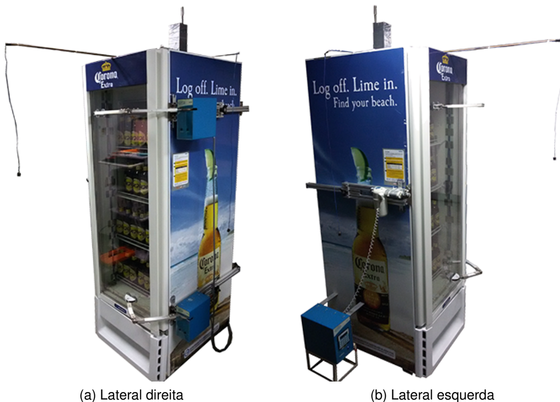
Figura 8 – Termopares para medição da temperatura ambiente, sonda para medição da umidade da sala, e mecanismo de abertura de porta automático.
