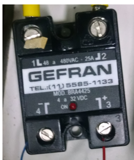
Figura 23 – Ilustração do relé de estado sólido utilizado.
