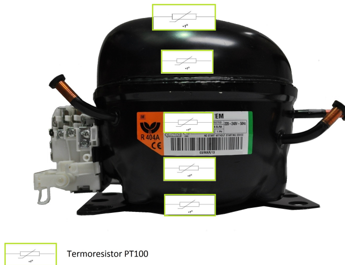
Figura 19 – Ilustração da posição dos termorresistores Pt100.
