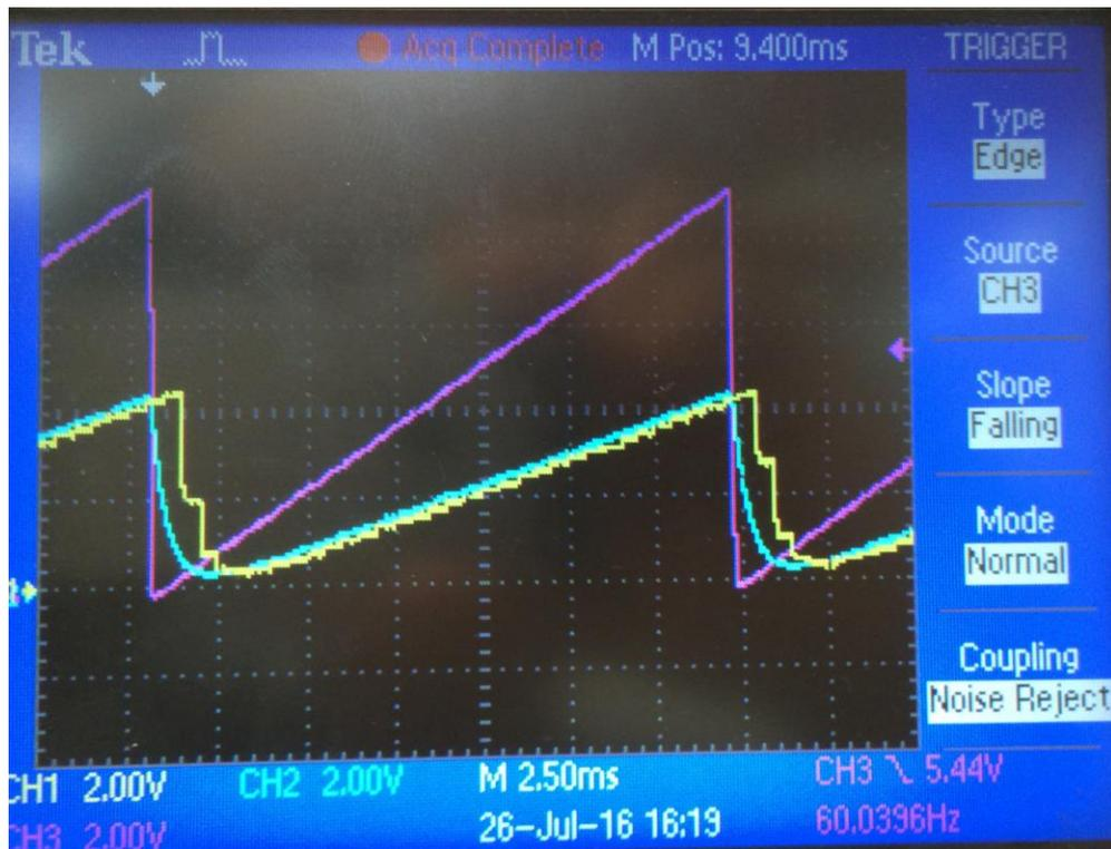
Figura 34 - Captura dos sinais referentes ao teste realizado nos componentes A/D e D/A
