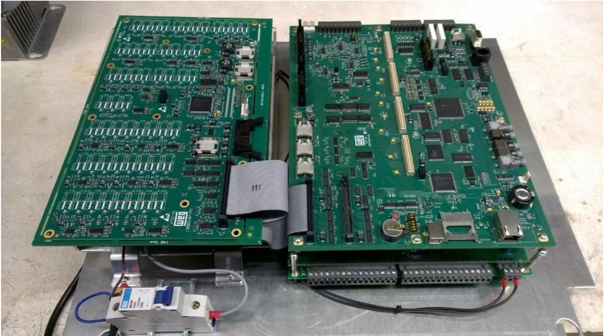
*Figura 1 - Protótipo da nova plataforma de cartões de controle*
