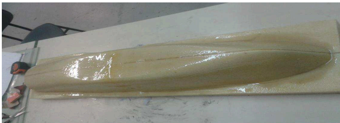
Figura 14: Selagem do poliuretano para acabamento com massa.
