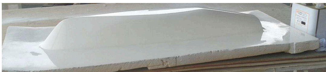
Figura 19: Superfície pronta para início da laminação do molde.
