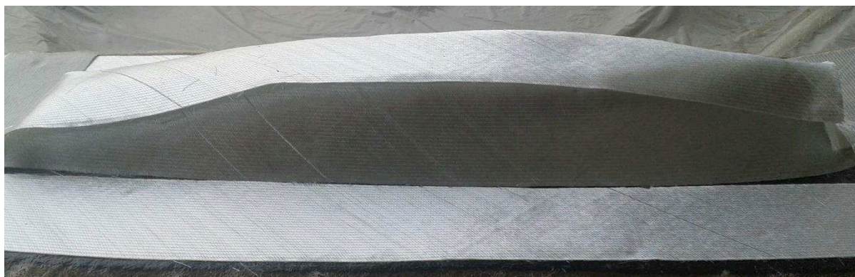
Figura 21: Camada de tecido combinado com manta.
