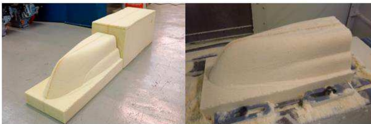
Figura 12: Proa usinada com detalhe ao ressalto lateral.
