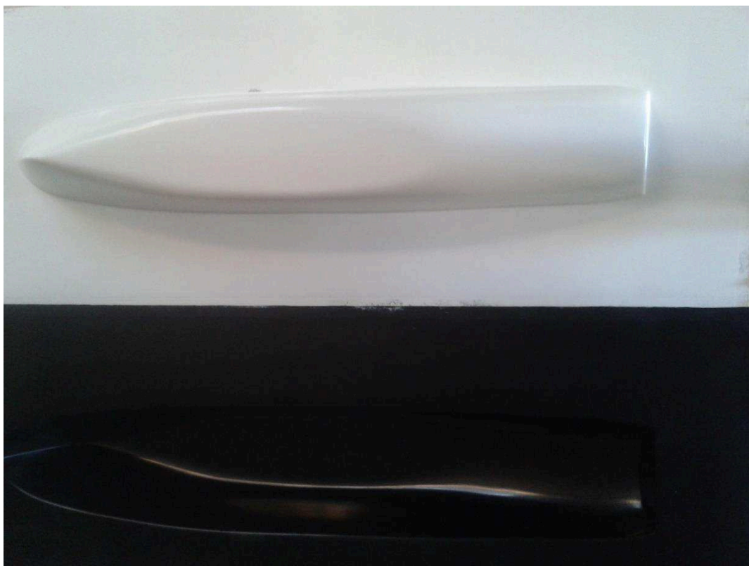
Figura 24: Molde rebarbado e peça tirada do molde.
