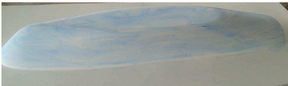
Figura 18: Manchamento do plug para acabamento com lixas.
