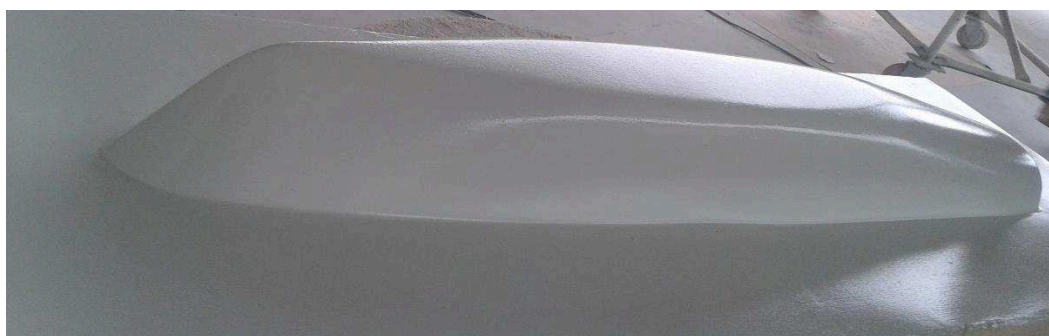
Figura 17: Pintura de gel coat.
