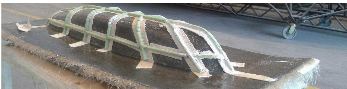
Figura 22: Reforços estruturais do molde.
