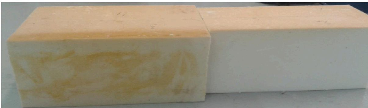
Figura 9: Bloco de poliuretano já faceado.
