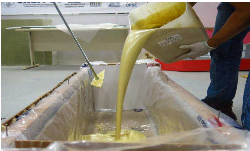
Figura 7: Poliuretano em estado líquido sendo depositado no molde.
