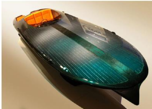
Figura 15 - Painéis colados ao casco na horizontal
