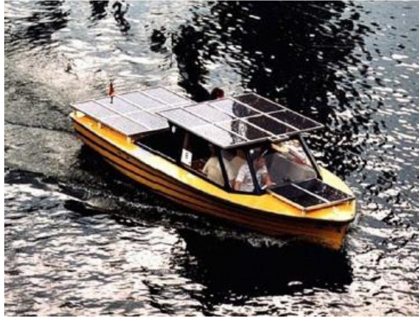
Figura 18 - Painéis na horizontal, como cobertura e colados ao casco
