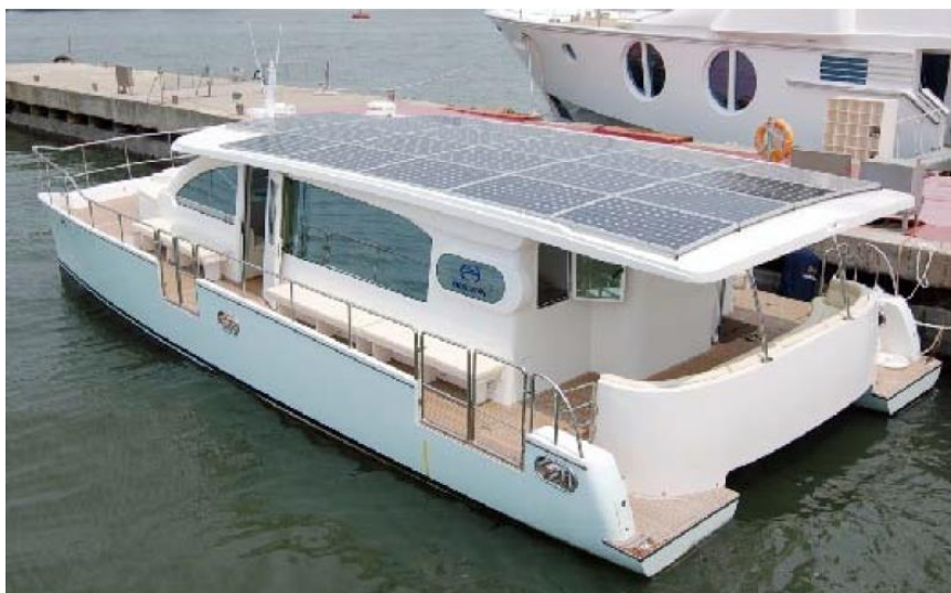
Figura 14 - Painéis na cobertura na horizontal barco SunCat 46
