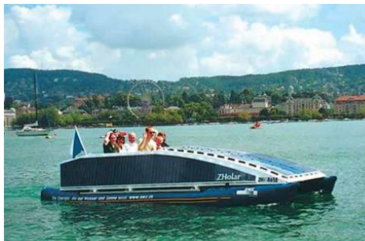
Figura 17 - Painéis colados ao casco e inclinados
