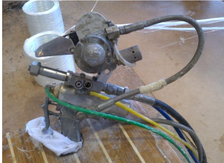
Figura 4– Revólver de laminação spray-up.
