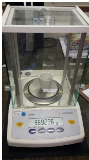
Figura 19 - Pesagem de um CP após Combustão
