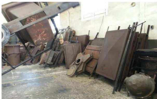
Figura 12 - Moldes em aço 1020 para rotomoldagem
