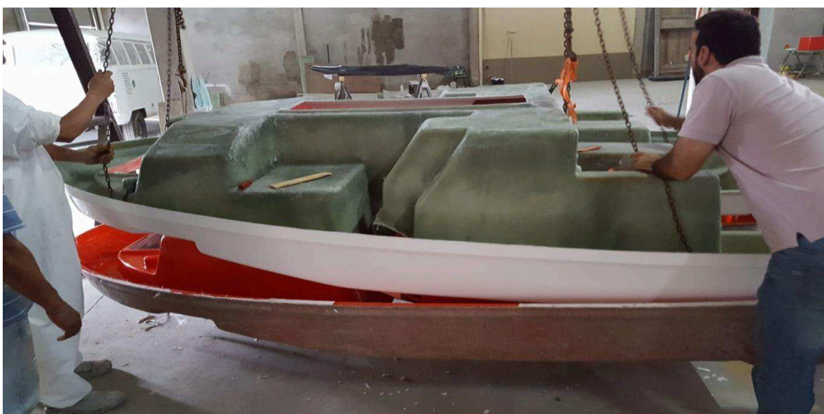
Figura 5 - Desmoldagem de um convés de PRFV
