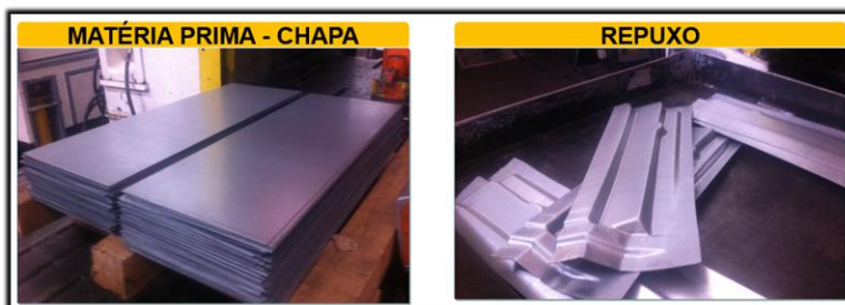
Figura 18 - Estampagem de peças: Deformação
