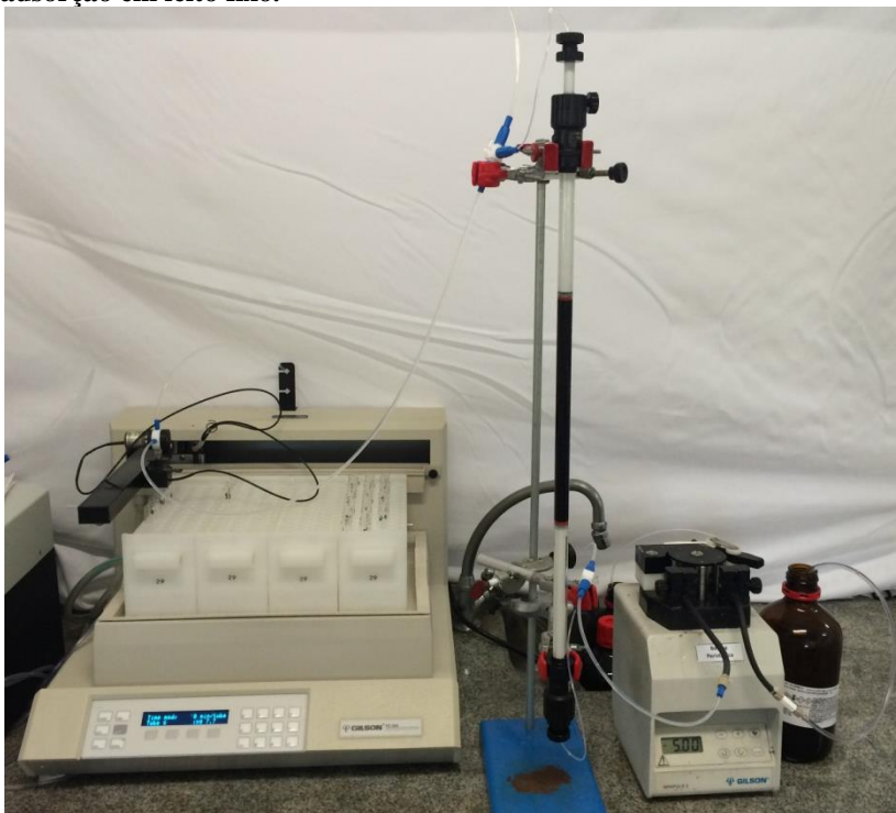
Figura 9. Unidade experimental utilizada para o experimento de adsorção em leito fixo.
