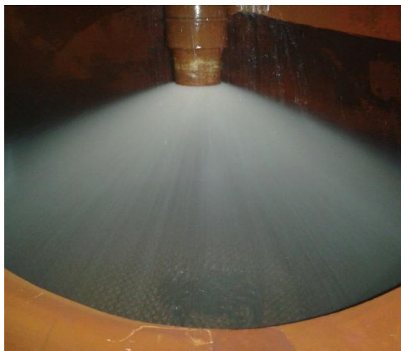
Figura 18: Foto ilustrativa do bico da seção de recirculação do lavador de gases. Bico fullcone com ângulo de 120°.
