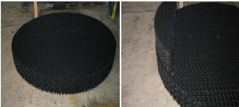
Figura 20: Montagem de uma seção do recheio estruturado.
