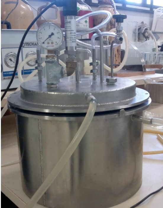
Figura 3-3 - Vaso de pressão para pré-solubilização de CO 2 em queijo Minas frescal.
