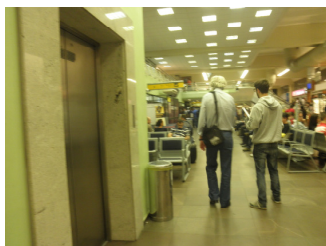
Figura I: Ausência de pisos táteis prejudica a identificação do elevador.
