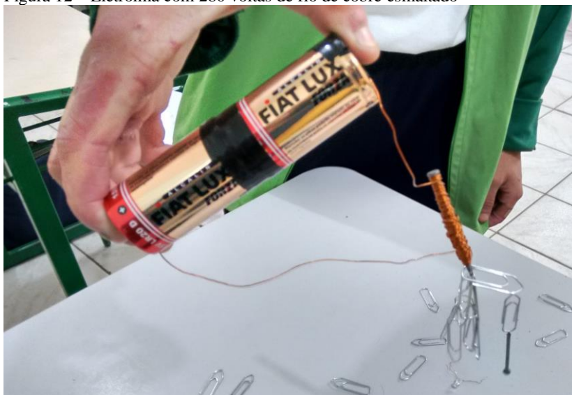
Figura 12 – Eletroímã com 280 voltas de fio de cobre esmaltado
