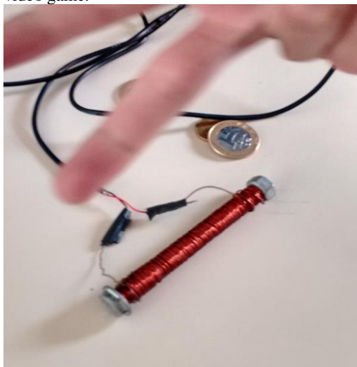
Figura 14 – Eletroímã montado com um carregador de celular e uma fonte de vídeo game.
