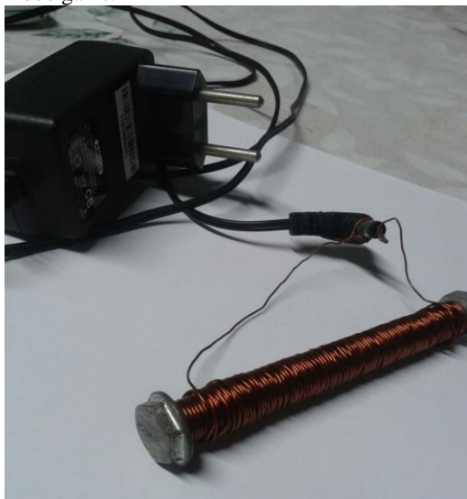
Figura 13 – Eletroímã montado com um carregador de celular e uma fonte de vídeo game.
