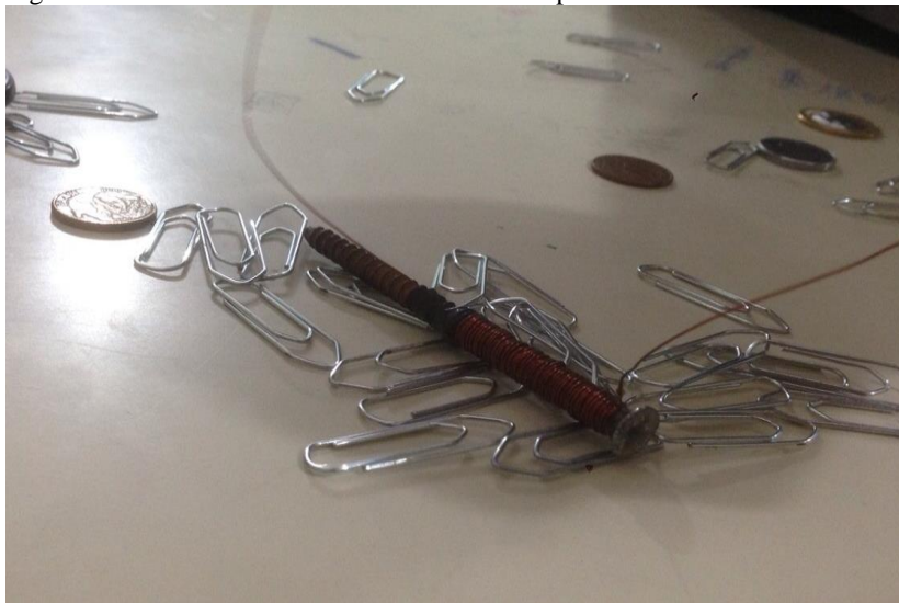
Figura 9 – Eletroímã construídos em sala de aula pelos alunos
