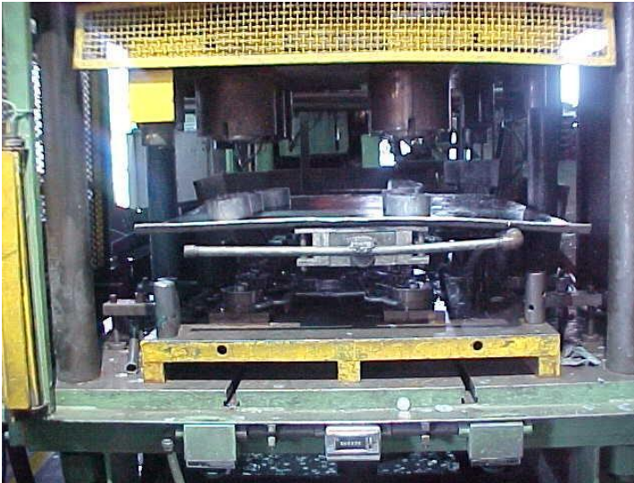
Figura 14: Prensa rebarbadora utilizada para remoção das rebarbas e canais de injeção das peças.
