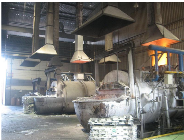
Figura 9 - Área dos fornos de fusão de alumínio
