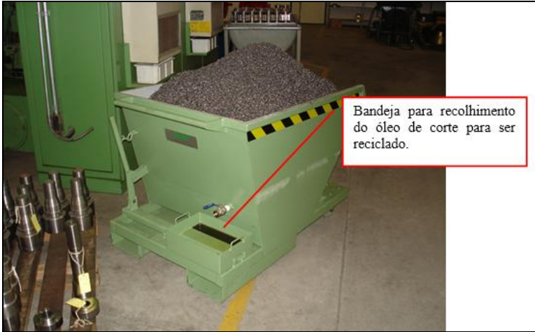
Figura 29: Modelo de caçamba utilizada pela empresa para recolher o óleo de corte.
