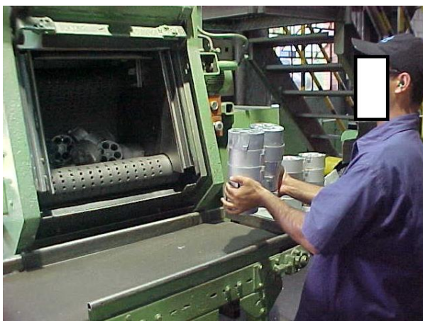
Figura 16: Equipamento utilizado para o jateamento das peças de alumínio.
