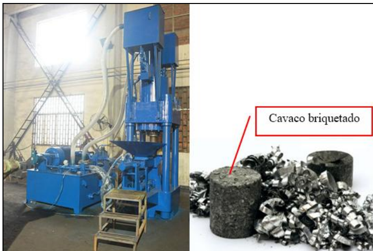
Figura 28: Briquetadeira de cavacos, cavaco de usinagem e o cavaco briquetado.
