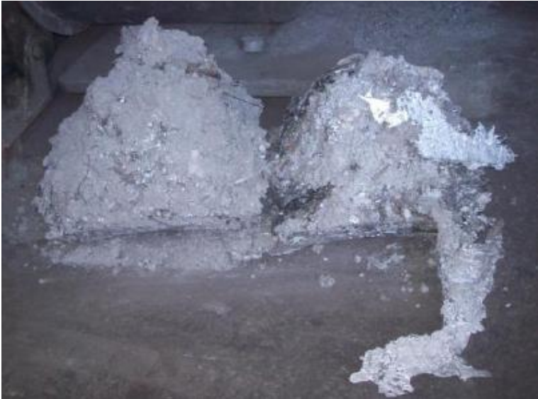
Figura 27: Borra de alumínio utilizado pela empresa como reuso.
