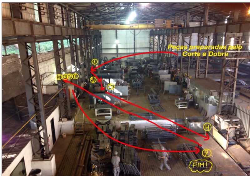
Figura 6 – Etapas do processo de fabricação dos quadros metálicos
