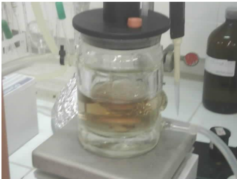
Figura 24. Foto registrada durante o processo de fotólise UV (fenol 50 \text{ mg L}^{-1} ) evidenciando a formação da coloração castanho avermelhada a partir do amarelo, sugerindo a formação de hidroquinona e benzoquinona como subprodutos.
