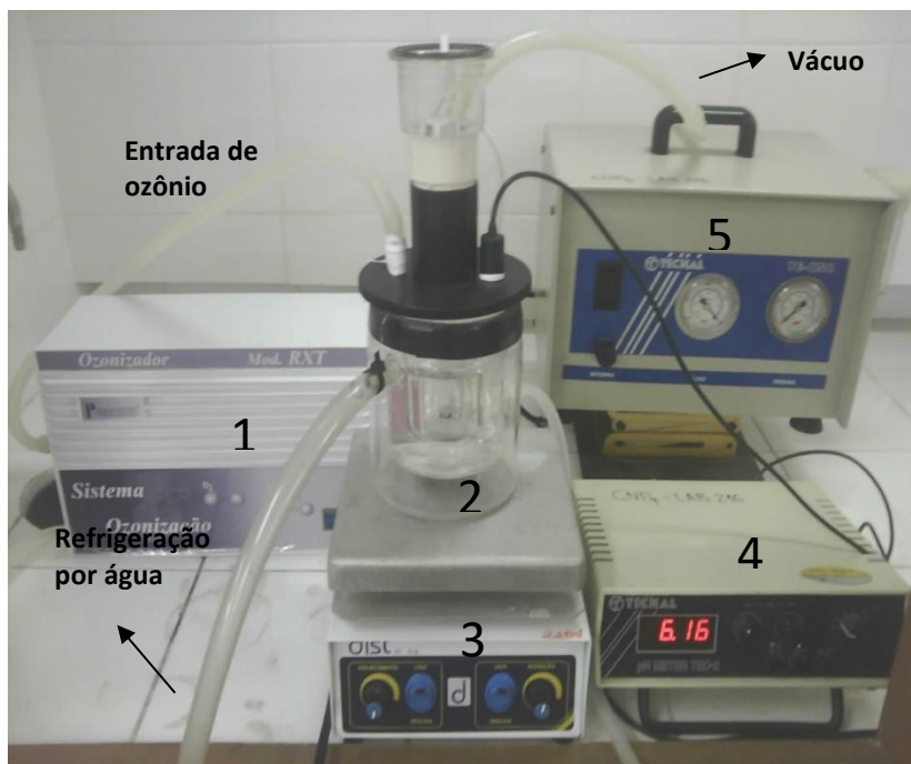
Figura 36. Sistema de ozonização composto por: 1) ozonizador; 2) reator fotolítico; 3) agitador magnético, 4) pHmetro e 5) bomba de vácuo
