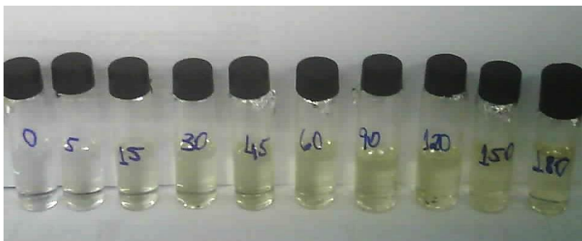
Figura 23. Perfil de evolução de cor em alíquotas da amostra de solução de fenol ( 50 \text{ mg L}^{-1} ) coletadas durante o tratamento via fotólise UV.
