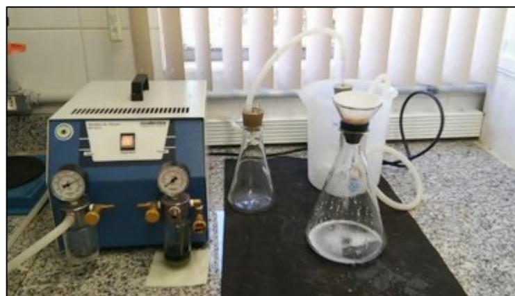
Figura 5 - Bomba de vácuo acoplada a kitassatos utilizados para lavagem e filtração dos materiais.
