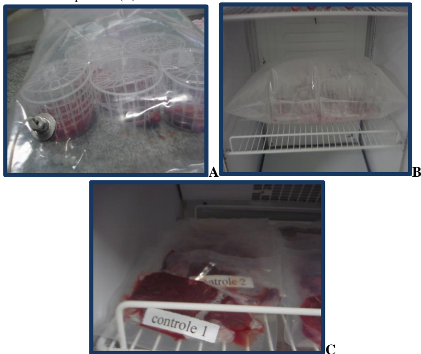
Figura 4.2. Imagens do processo SGS no momento da injeção do gás (A), durante o período de absorção do gás no produto (B), acondicionamento individual do produto (C)
