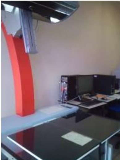
Fotografia 23 – Scanner planetário utilizado na digitalização das obras raras
