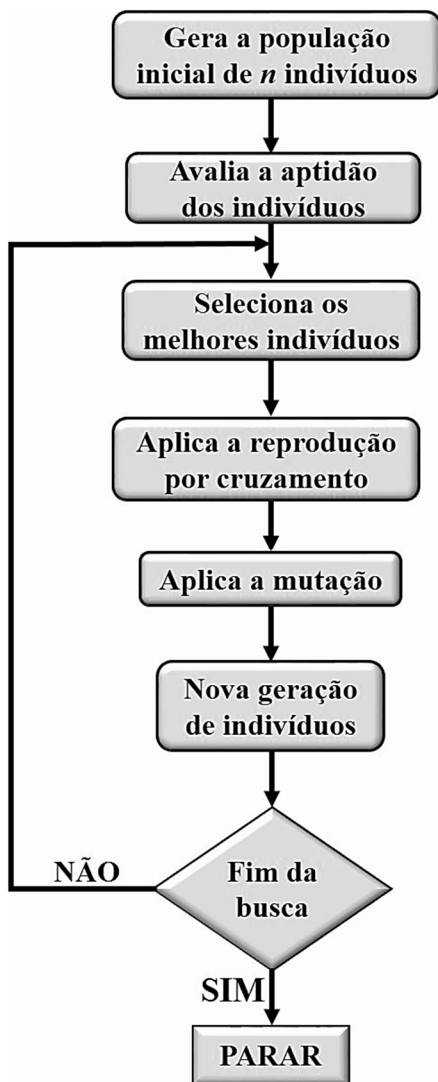
Figura 18 - Fluxograma do funcionamento de um algoritmo genético (AG) tradicional.
