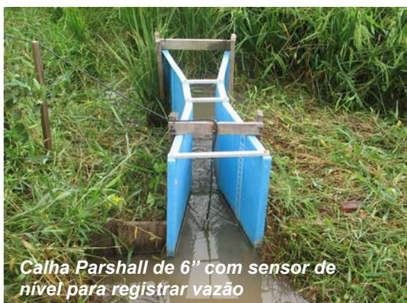
*Calha Parshall de 6" com sensor de nível para registrar vazão*
