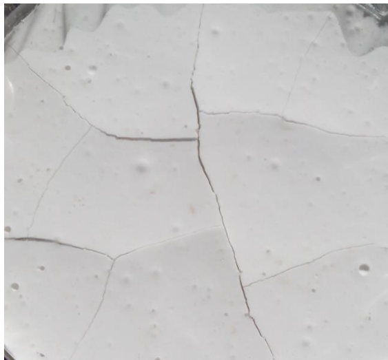
Figura 4 - Rachaduras geradas durante a secagem na superfície do amido de mandioca fermentado.
