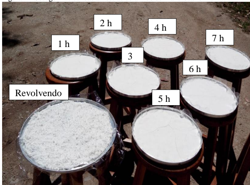
Figura 2 - Secagem ao sol das amostras de amido de mandioca fermentado.
