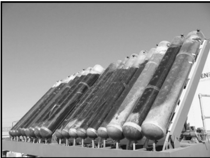
Figura 3 - Fotobiorreator tubular inclinado para o cultivo industrial de microalgas.
