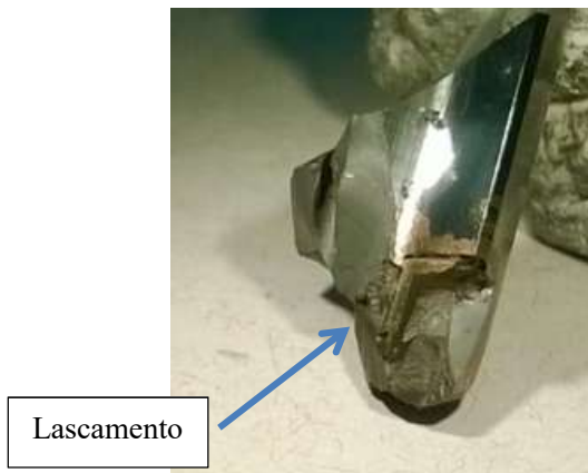
Figura 5. 21 - Trinca no corpo da broca, que inicia na região do alojamento do inserto.
