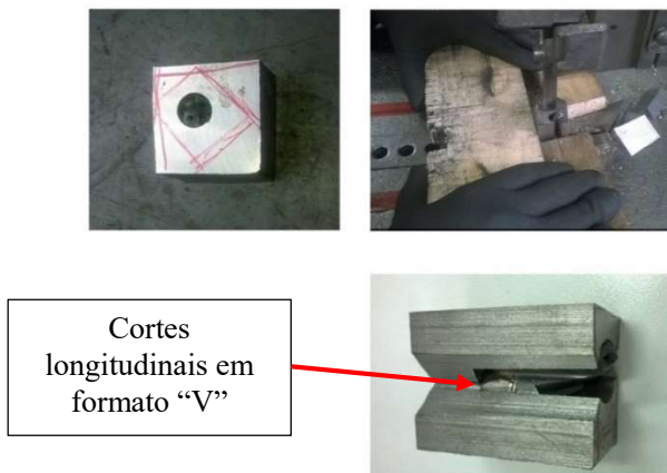
Figura 5. 23 - Preparação da amostra para análise. Em sentido horário: marcação do corpo de prova, corte e corpo de prova preparado para análise.
