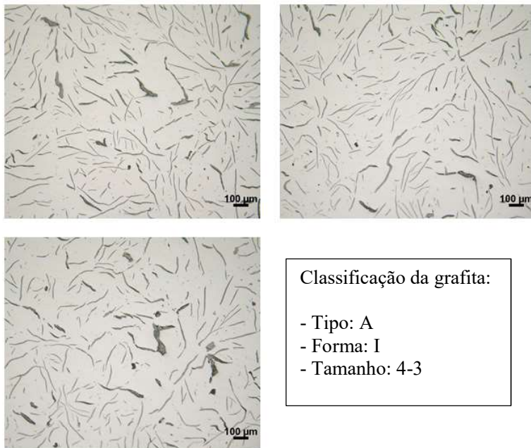
Figura 5. 1- Micrografia de diferentes pontos amostra para classificação da grafita. Ampliação: 100x.
