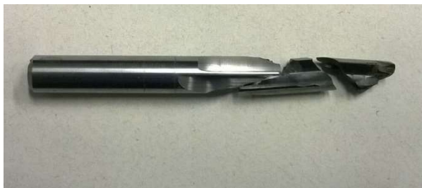
Figura 5. 18 – Partes da broca quebrada na Prova 2 após 11 mm de furação.
