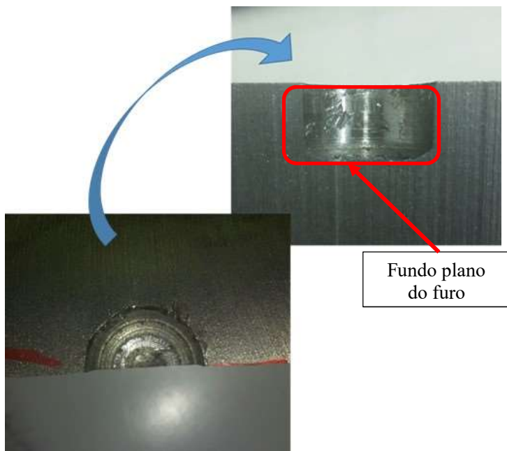
Figura 5. 20 - Seccionamento do furo para análise. No detalhe: região plana no fundo do furo.
