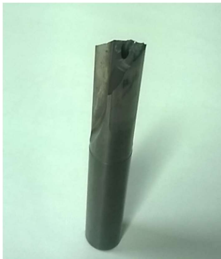
Figura 5. 39 - Broca de inserto de PCBN integral quebrada - teste sem refrigeração.
