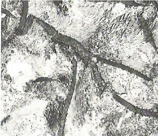
Figura 3. 13 - Microestrutura Típica de Ferro Fundido Cinzento. Grafita em forma de veios dispersas em matriz perlítica.
