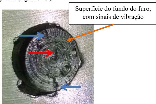
Figura 5. 19 – Análise do fundo do furo gerado. Em azul: início do corte, diâmetro próximo ao diâmetro externo. Em vermelho: início do corte, próximo ao centro.
