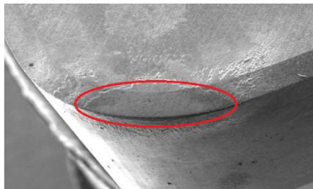
Figura 3. 16 - Camada de sulfeto de manganês formada sobre ferramenta de PCBN. Velocidade de corte: 800 m/min. Inserto com 50% de grãos de CBN. Fonte: Gastel et al. (2000)
