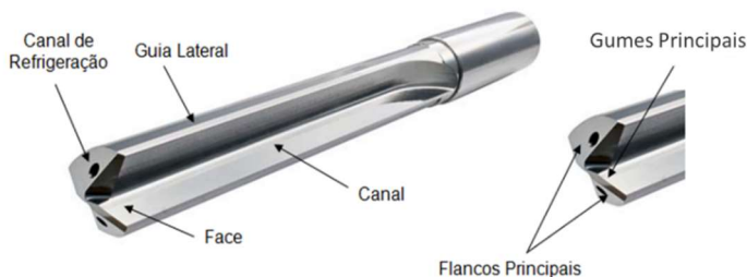
Figura 3.3 - Elementos de brocas de canal reto.
