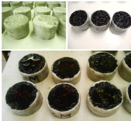
Figura 4.14 - Procedimento determinação dos vazios comunicantes
