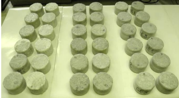
Figura 4.5 - Corpos de prova com fita adesiva e parafina
