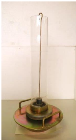
Figura 3.5 - Permeâmetro LCS utilizado no ensaio
