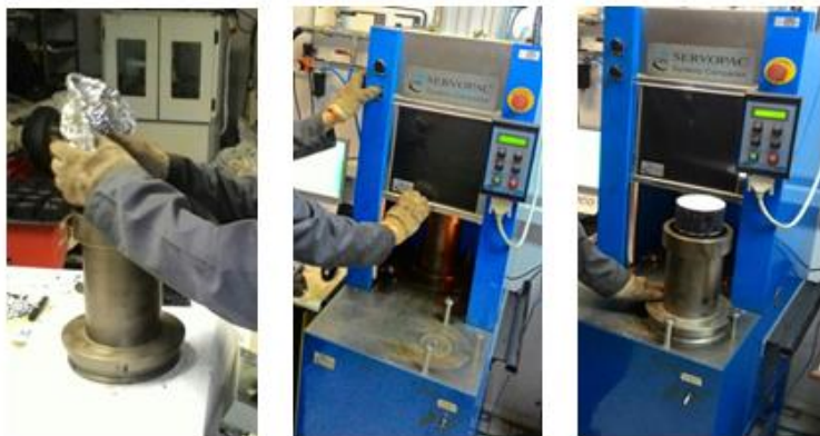
Figura 4.3 - Procedimento de compactação dos corpos de prova no CGS
