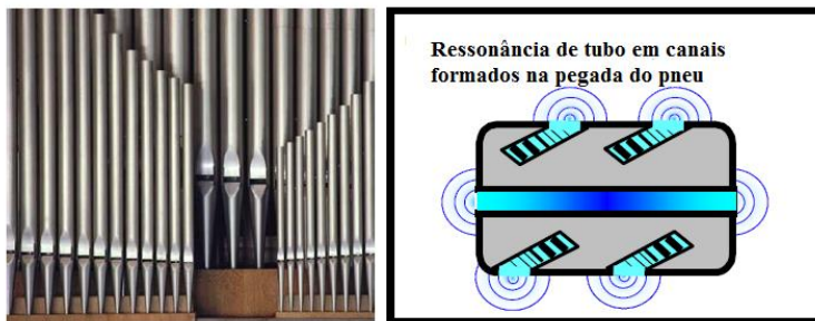
Figura 2.13 - Efeito Ressonância de tubo
