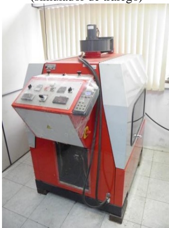
Figura 3.6 - Equipamento Orniéreur para avaliação da deformação permanente (simulador de tráfego)
