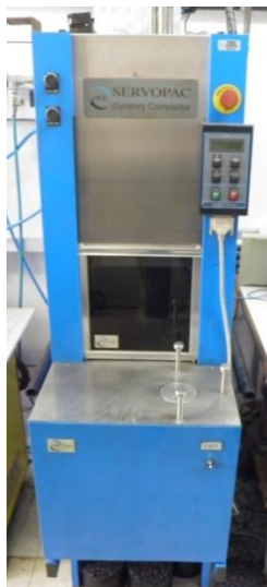
Figura 3.3 - Compactador Giratório Superpave
