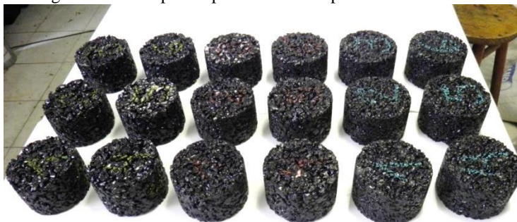
Figura 4.24 - Corpos de prova moldados para o ensaio Lottman
