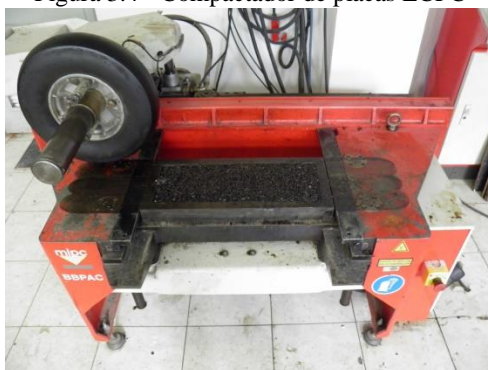
Figura 3.4 - Compactador de placas LCPC
