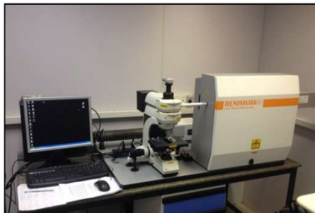
Figura 11 – Equipamento utilizado para realização de espectroscopia Raman.
