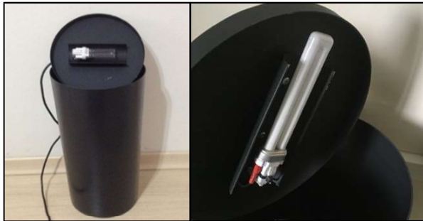
Figura 13 – Dispositivo utilizado na irradiação ultravioleta dos filmes.
