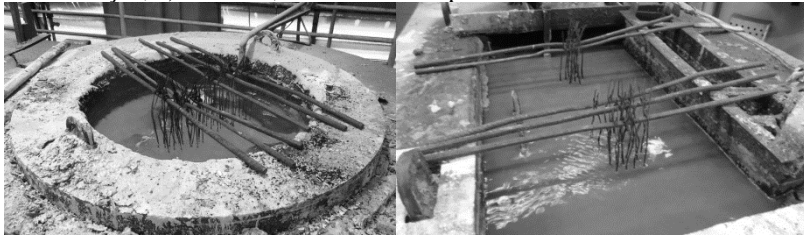
Figura 46 – Fornos utilizados no tratamento térmico: a) A esquerda, forno de austenitização; b) A direita, forno de austêmpera.
