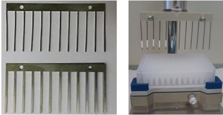
Figura 17 – Modificações do sistema de 96-well plate.
