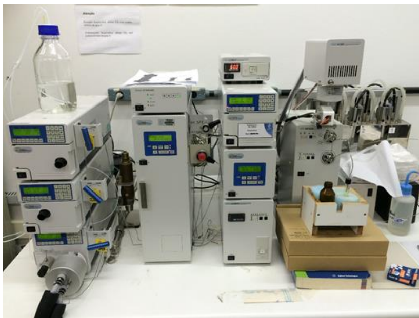
Figura 8: Extrator supercrítico modelo HPLC-SC, Jasco Inc. utilizado para a obtenção do extrato de patchouli.
