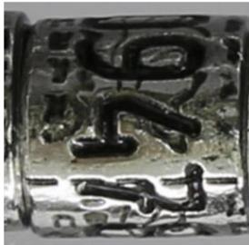
Exemplos de **anilhas falsificadas por contrafação** (forjada clandestinamente) – contrafação correspondente a modelo fabricado a partir de 2012, contendo a sigla “SISPASS”.
