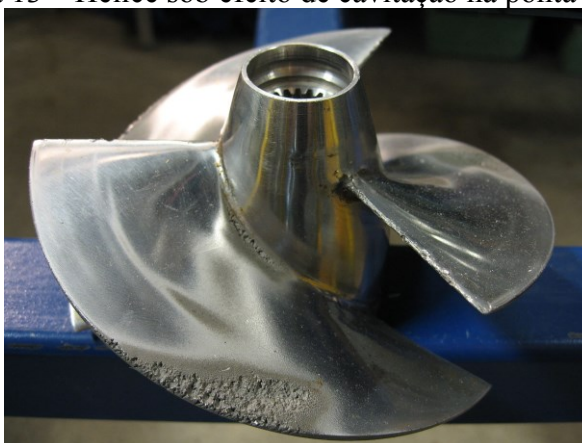
Figura 13 – Hélice sob efeito de cavitação na ponta das pás
