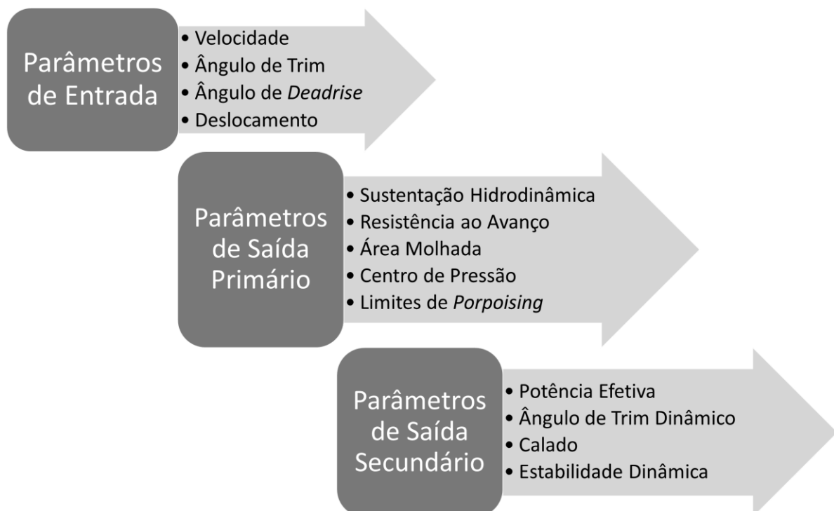
Figura 11 - Representação gráfica dos parâmetros de entrada e saída da metodologia de Savitsky.
