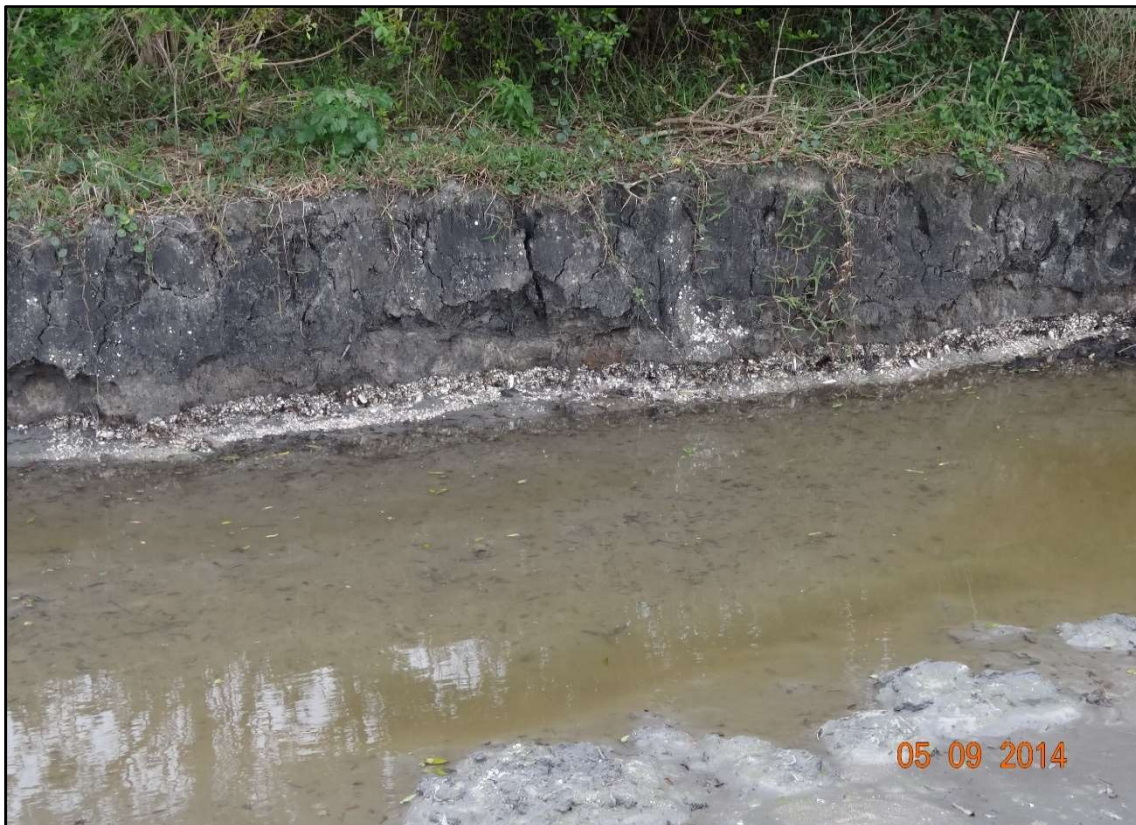
Foto 61: Detalhe das cavas de exploração em mina a céu aberto dos jazimentos de conchas calcárias, explotado pela Empresa CYSY Mineração Ltda.
