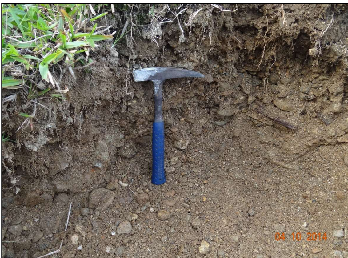
Foto 15: Detalhe do Depósito aluvial (corte na fácies de planície de inundação), adjacente ao rio Pirabeiraba, constituído de cascalhos e sedimentos arenosos, mal selecionados.
