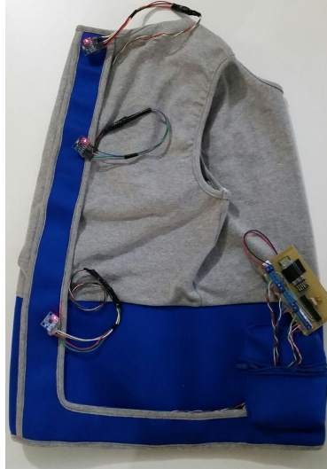
Figura 34 – Componentes instalados na roupa especialmente desenvolvida para o sistema vestível
