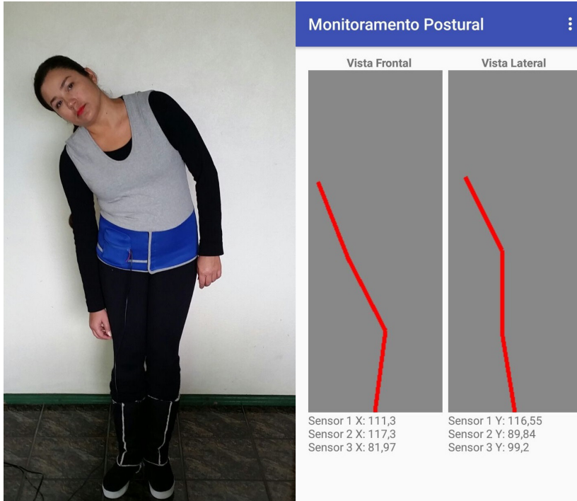
Figura 36 – Primeiro teste realizado no sistema vestível. Na Esquerda, o sistema vestível sendo usado e na direita o resultado mostrado pelo aplicativo.
