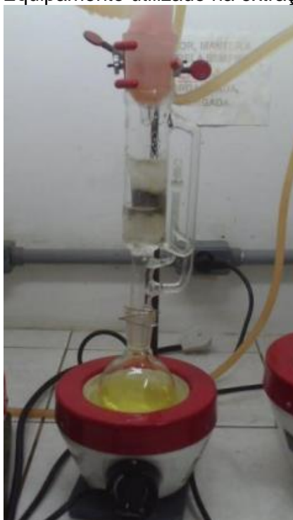
Figura 5 – Equipamento utilizado na extração Soxhlet.
