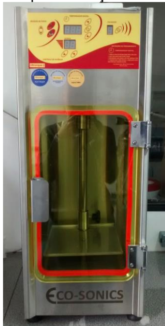
Figura 6 – Equipamento para extração em sonicator ultrassônico.
