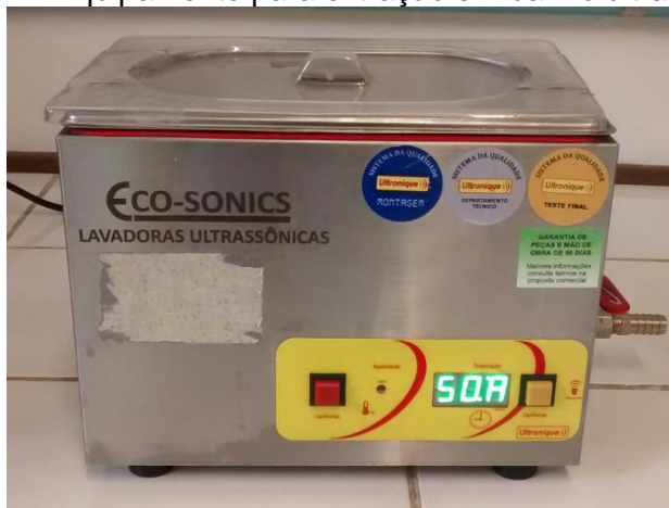
Figura 7 – Equipamento para extração em banho ultrassônico.
