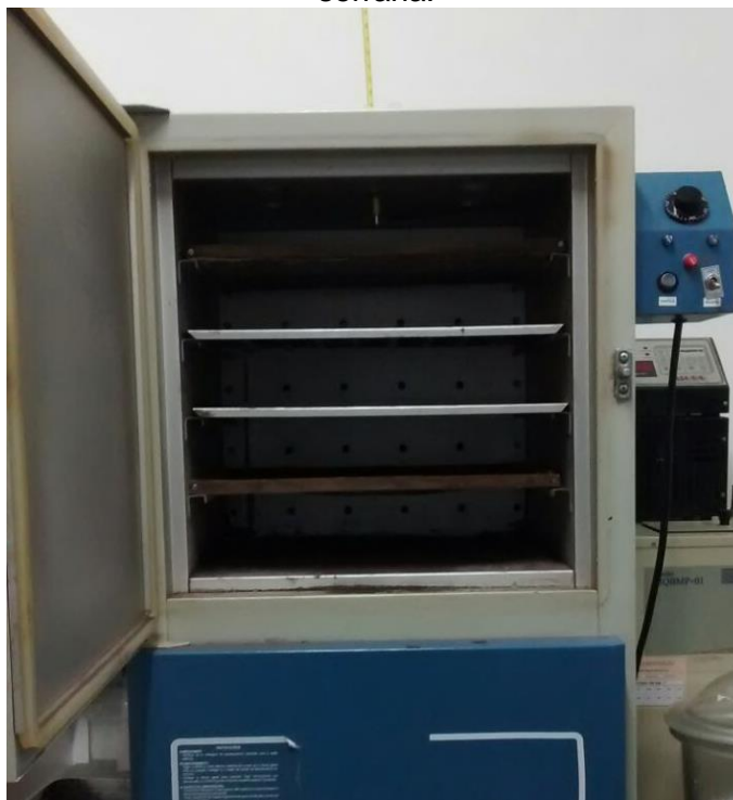
Figura 4 – Estufa com circulação forçada de ar utilizada na secagem da folha de goiaba-serrana.
