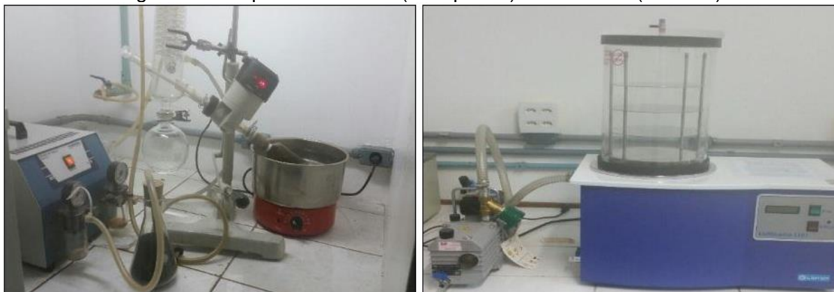
Figura 8 – Evaporador rotativo (à esquerda) e liofilizador (à direita).
