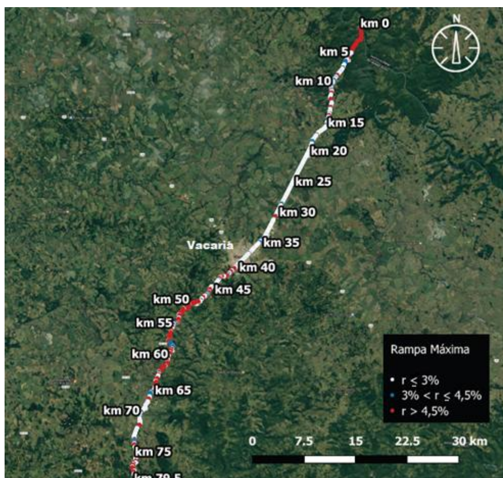
Figura 5.4: Subdivisão do segmento a partir da inclinação da rampa máxima.
