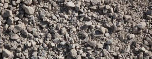
Figura 5.3 - Material granular não tratado utilizado na França (Grave non traitée 0/20mm).
