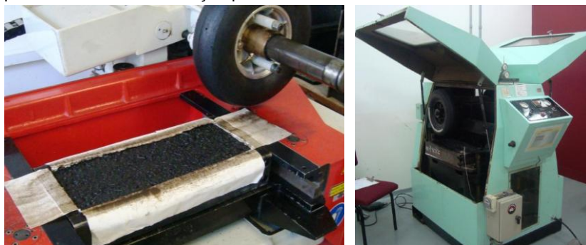
Figura 2.5 - Compactação de placa em equipamento pneumático e máquina para o ensaio de deformação permanente.
