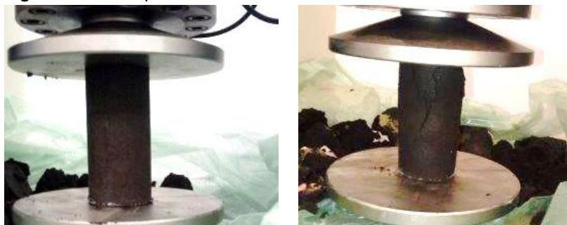
Figura 6.28 - Rompimento de uma das misturas de solo/calcário.
