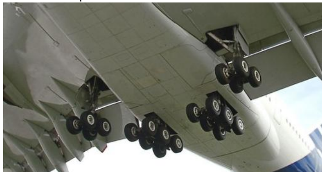
Figura 7.5 - Trens de pouso do Airbus A380-800.
