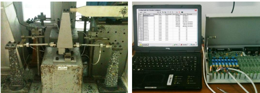
Figura 2.8 - Corpos de prova na máquina de ensaio e sistema aquisitor de dados.
