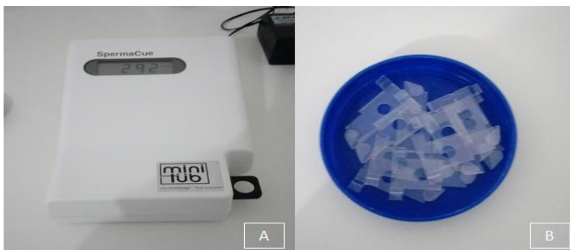
Figura 15 – Espectrofotômetro utilizado pelo sistema de análise manual para determinar a concentração espermática (A); Microcuveta onde era depositada a gota de sêmen e em seguida introduzida no aparelho para leitura (B);
