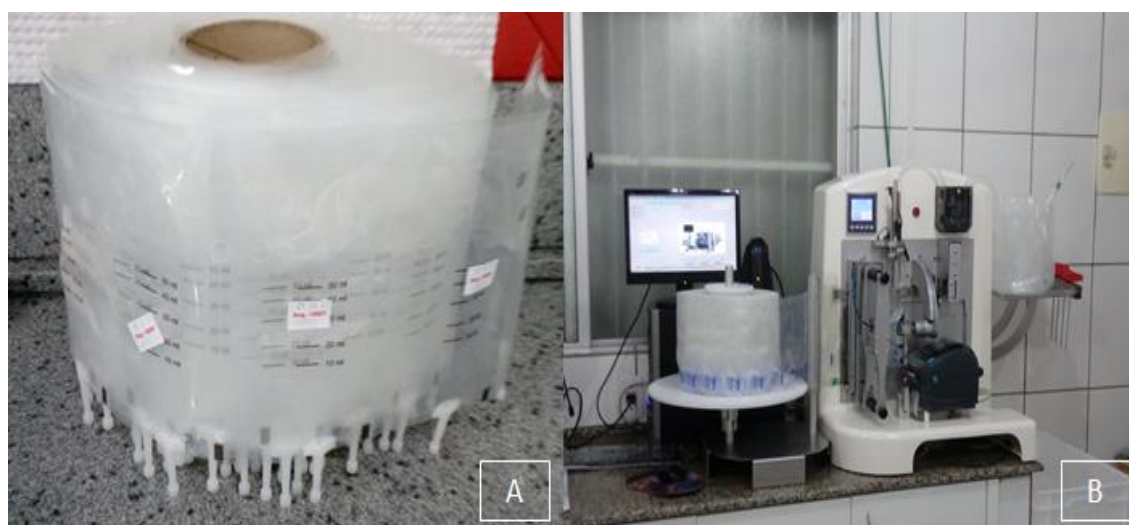
Figura 17 – Blister utilizados para envase das doses inseminante (A); Equipamento utilizado para o envase automático das doses inseminantes (B);
