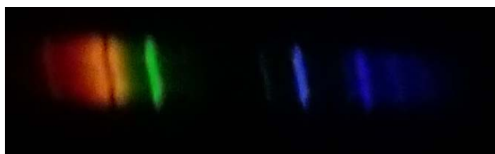
Figura 14: Espectro de emissão visto pelos alunos através do espectrômetro caseiro. Fonte: fotografado pelo autor.
