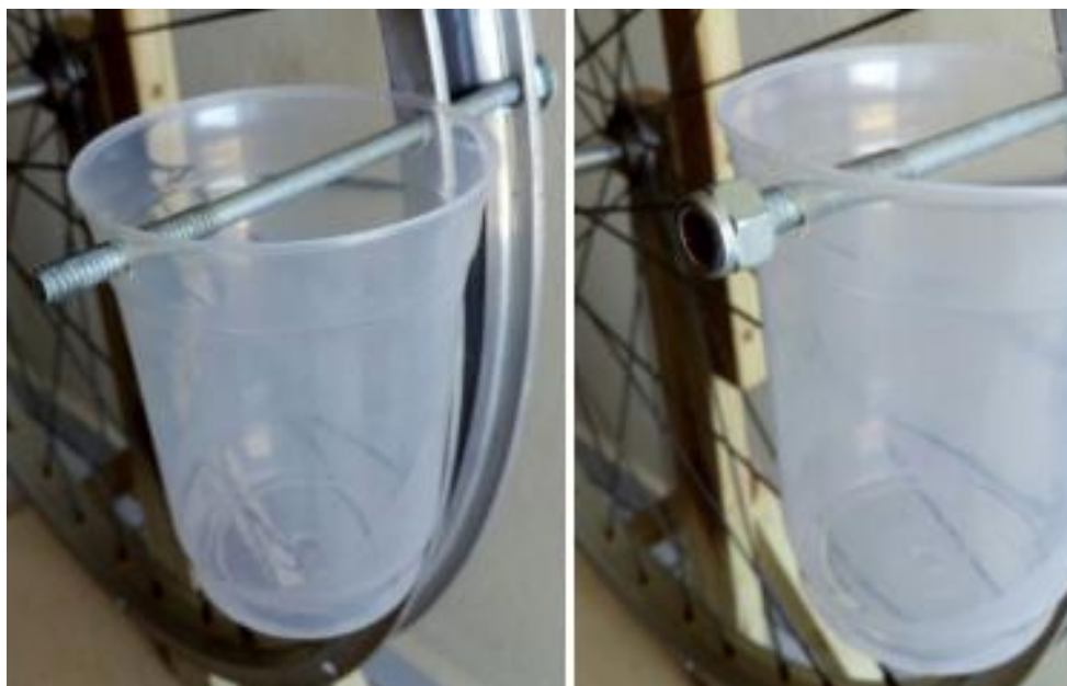
Figura 14: Montagem da roda da água. Fonte: arquivo da autora.
