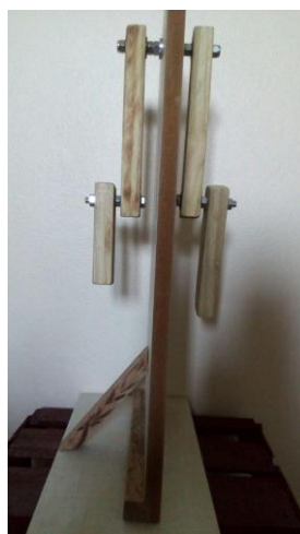
Figura 3.3 Um pêndulo duplo é composto por uma base e duas hastes móveis presas entre si.
