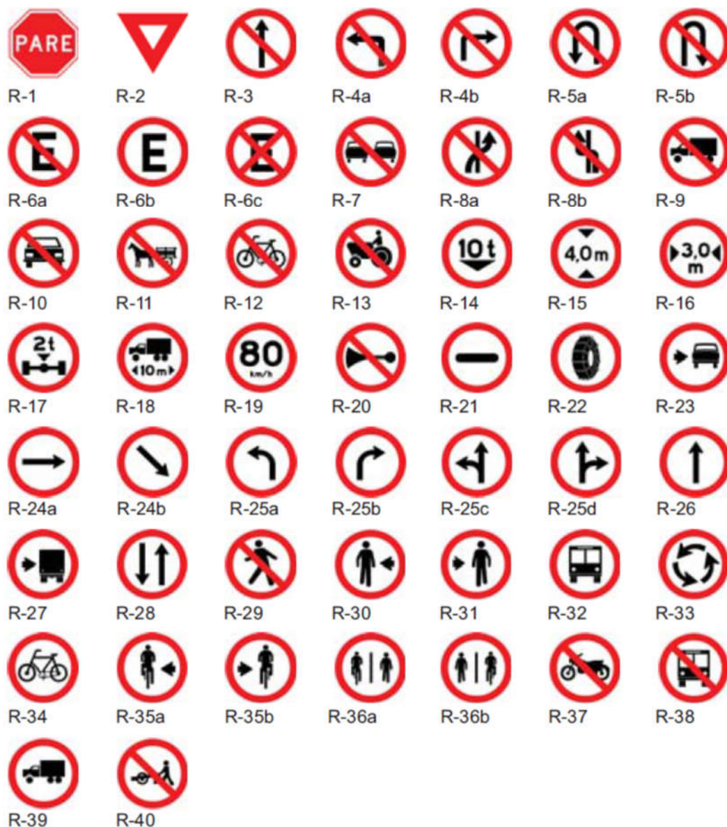
Figura 12 - Sinais verticais de regulamentação
